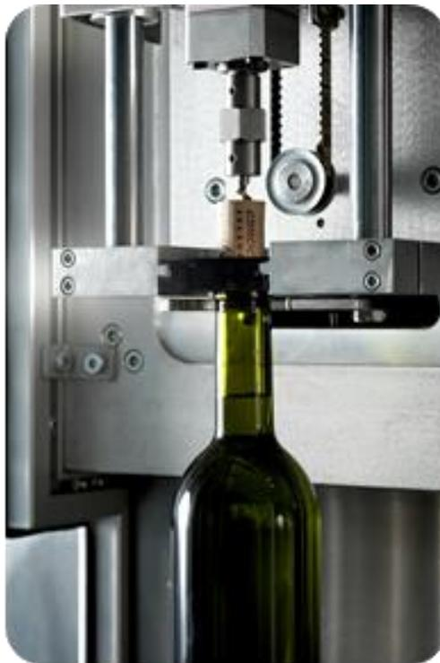
verificación del correcto mordazas de compresión comprimen hasta alcanzar inicial del tapón de corcho **diámetro de compresión**). efectuarse antes de envasado.
